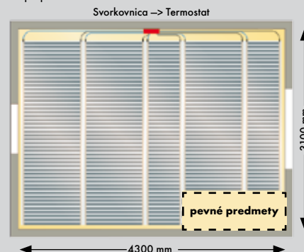
zapojenie sád ECOFILM SET
